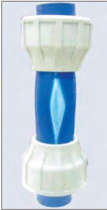
Requisitos de rendimiento para los accesorios de compresión Plast / Prueba del accesorio
